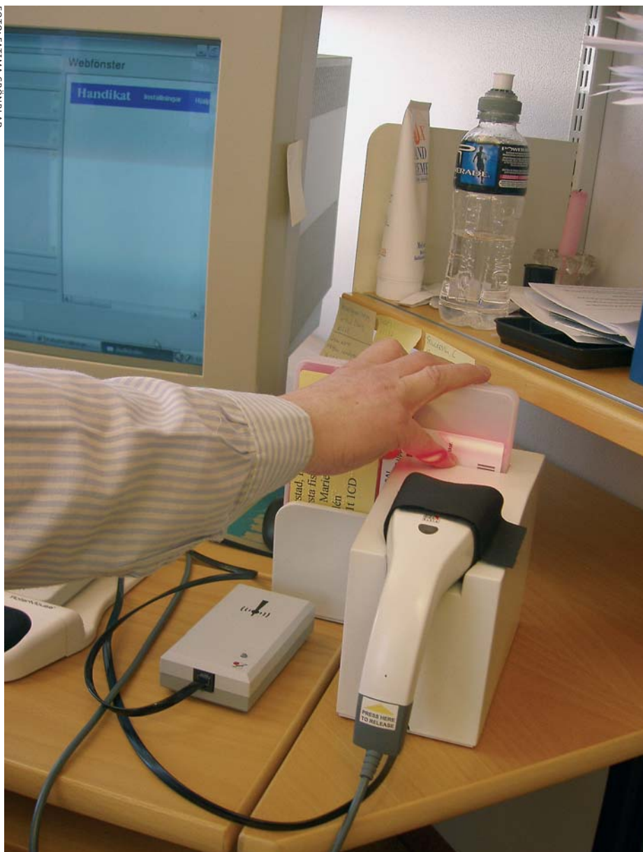
Registreringen av talböckerna görs i en specialgjord apparat som kopplar ihop RFID-taggen med en viss post i bibliotekets databas.
